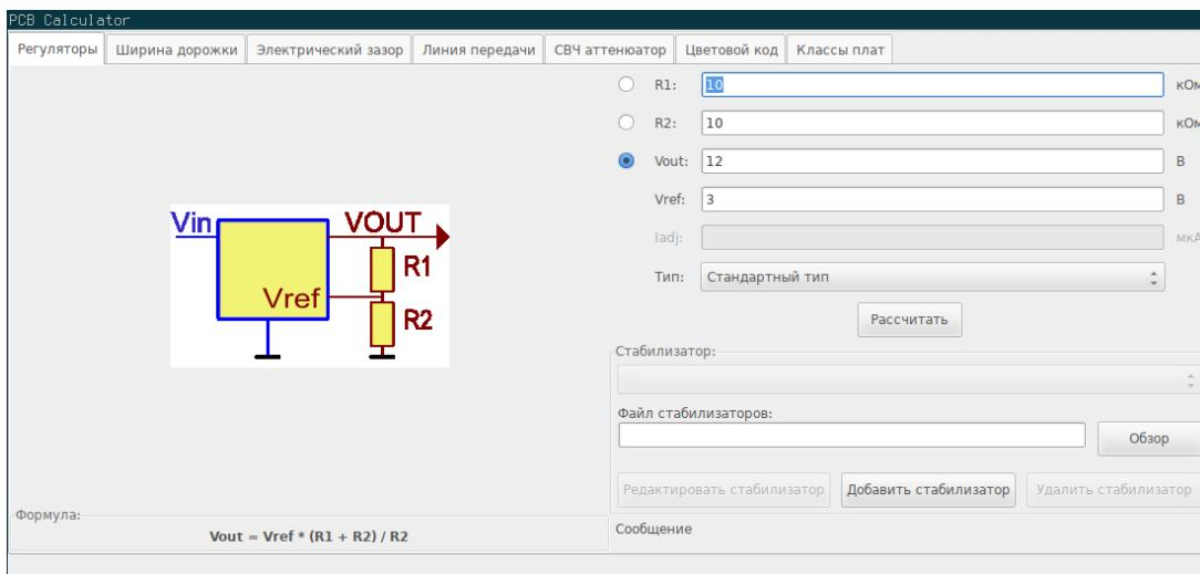
Для стандартного типа регуляторов, выходное напряжение  $V_{out}$  является функцией от опорного напряжения  $V_{ref}$  и сопротивления резисторов  $R_1$  и  $R_2$ , и вычисляется по формуле:
